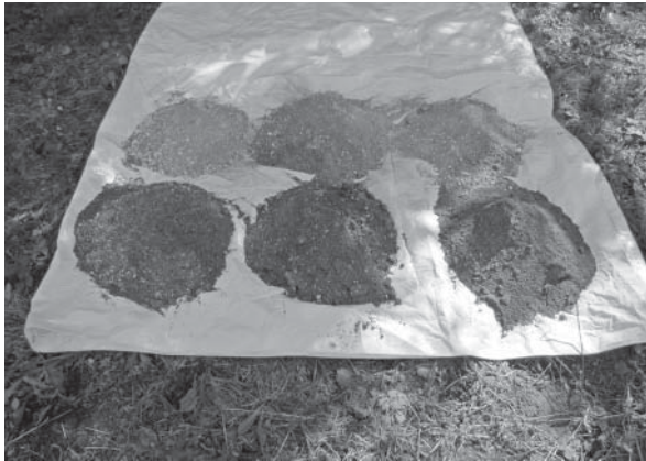
Abbildung 3 Probenahme von Brennraumasche. Entnommene Teilmengen vor der Vereinigung, Homogenisierung und Verjüngung. Bildrechte: BGH
